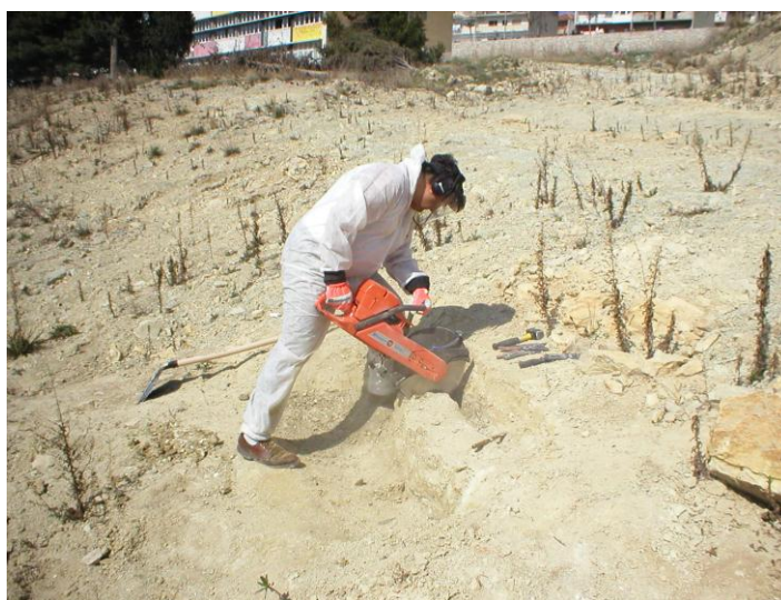
Slika 3.2. Primjer uzorkovanja na terenu upotrebom dijamantne pile
