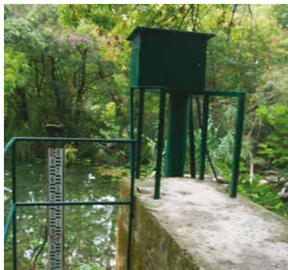
Slika 3: Limnigraf vodomjerne postaje Skradinski buk gornji snimljen 6. listopada 2015. (snimila: T. Roje-Bonacci)
