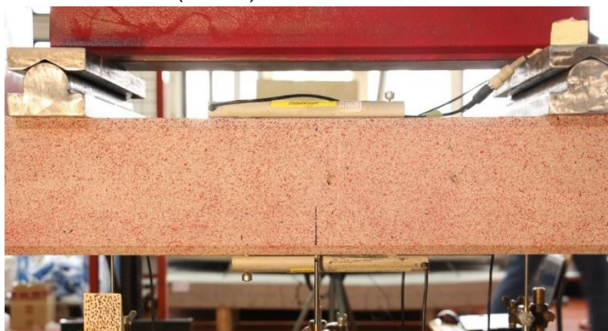
Slika 1. Površina uzorka pripremljena za digitalnu analizu slike
