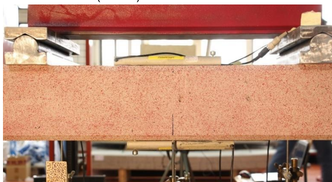
Slika 1. Površina uzorka pripremljena za digitalnu analizu slike
