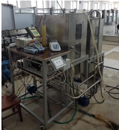
Slika 1. Pilot EK-a uređaja instaliran u hidrotehničkom laboratoriju Građevinskog fakulteta Sveučilišta u Zagrebu
